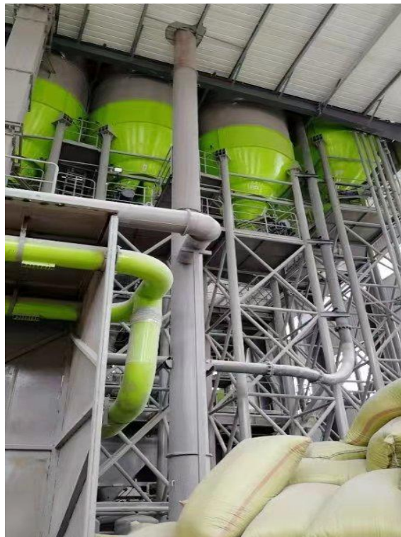
石膏砂浆生产线投料、搅拌工序脉冲布袋除尘器及排气筒
