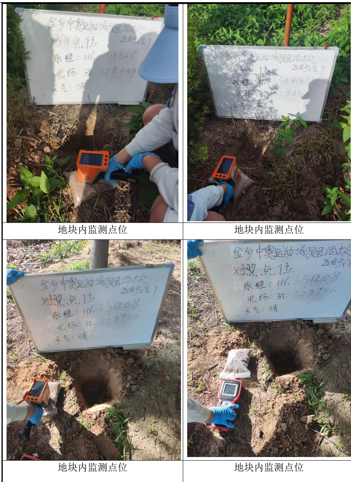
图5-4 现场快速检测照片
